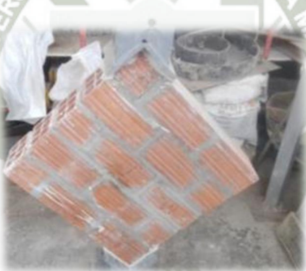
FIGURA N° 62 Muretes de ladrillo mecanizado (Fuente propia)
