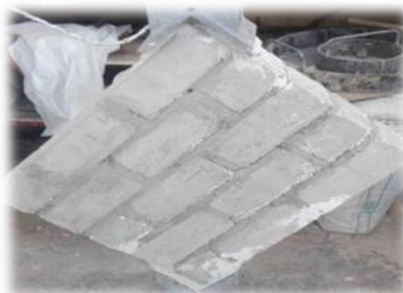
FIGURA N° 63 Muretes de ladrillo de concreto liviano (Fuente propia)
