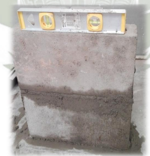
FIGURA N° 72 Pilas de bloques de concreto (Fuente propia)
