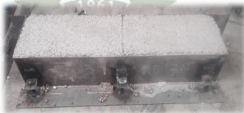
FIGURA N° 50 Molde doble de ladrillo de 13 cm x 10 cm x 24 cm con concreto liviano (Fuente propia)
