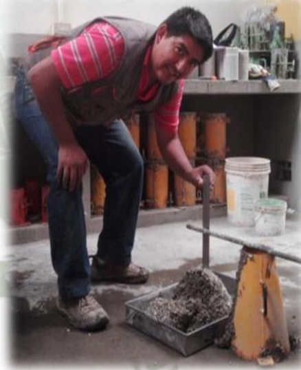
FIGURA N° 44 Medición de su asentamiento o Slump (Fuente propia)
