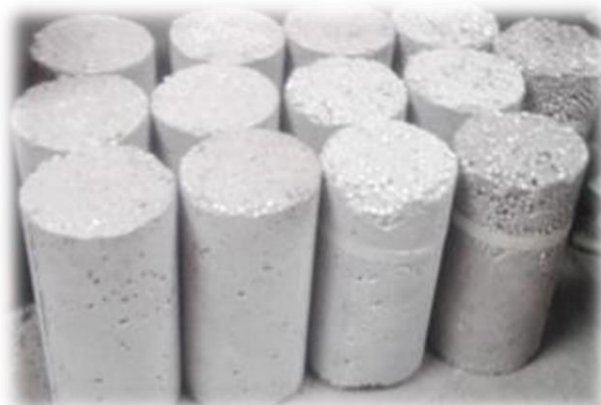
FIGURA N° 67 Probetas de concreto liviano (Fuente propia)
