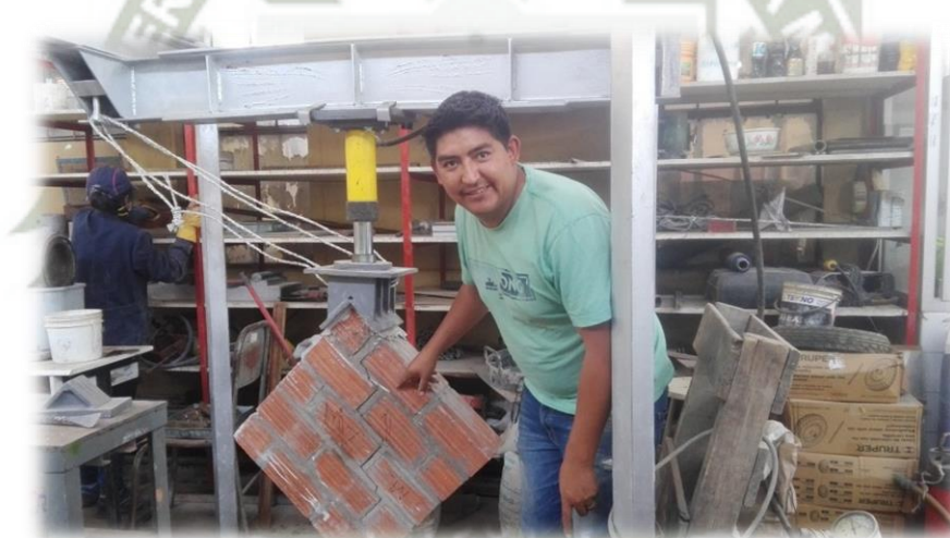
FIGURA N° 64 El ensayo de muretes de ladrillo mecanizado se hizo en el laboratorio de la Universidad Nacional de San Agustín (Fuente propia)
