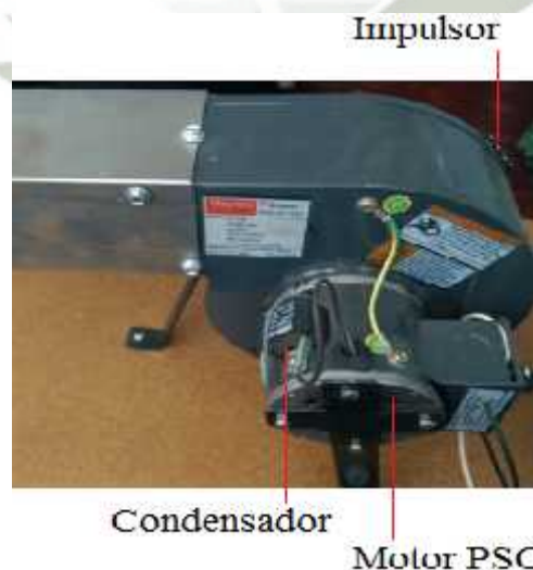
Figura 3.12: Ventilador Centrifugo Fuente: Fotografía
