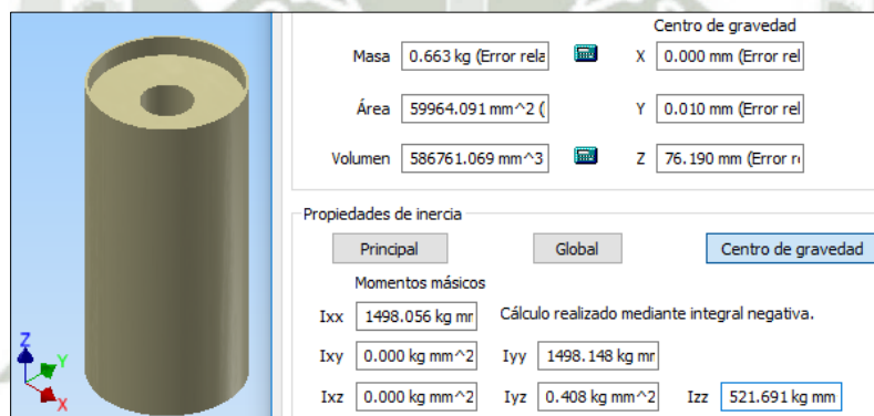
FIGURA 95: Cálculo de Inercia de Rodillo Motriz – Autodesk Inventor
