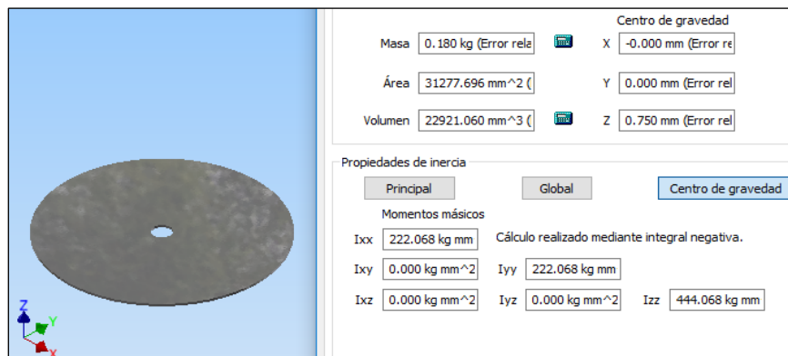
FIGURA 86: Cálculo de Inercia de Plato Rebobinador– Autodesk Inventor
