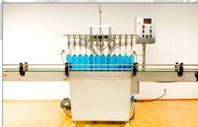
FIGURA 4: Línea de llenado de envases PET automatizado
