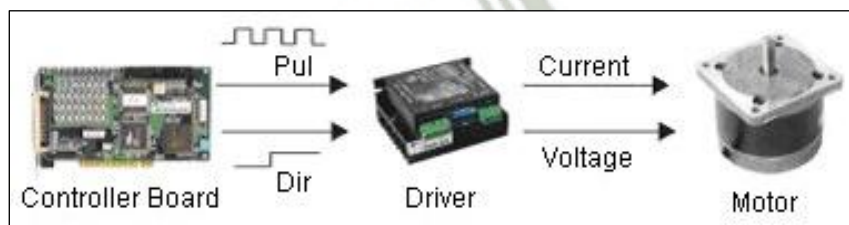
FIGURA 108: Diagrama de operación de un motor PaP, driver y PLC
