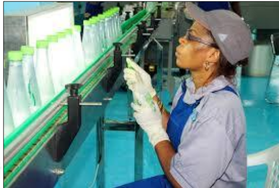
FIGURA 40: Control de Calidad de envases en sistema de transporte
