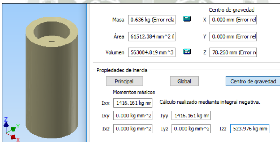
FIGURA 97: Cálculo de Inercia de Rodillo Motriz – Autodesk Inventor
