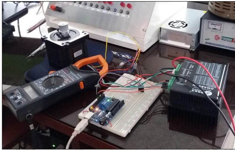
FIGURA 126: Prueba de conexión entre Driver y motor PaP con Arduino UNO.
