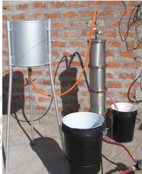
Figura 13. Sistema de anaerobiosis, Reactor Anaerobio de Flujo Ascendente (configuración final).
