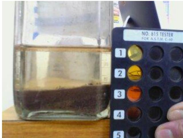
*Figura 3.2. Vista de la comparación de impurezas orgánicas con del Patrón Gardner #11 para el agregado fino.*
