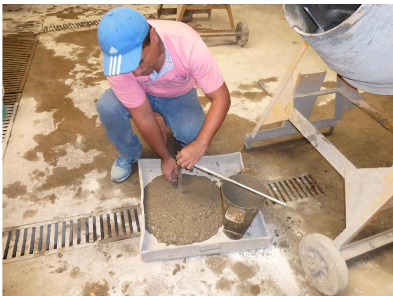
*Fotografía 09: Verificando el slump del concreto con la influencia de la microsílíce y superplastificante.*
