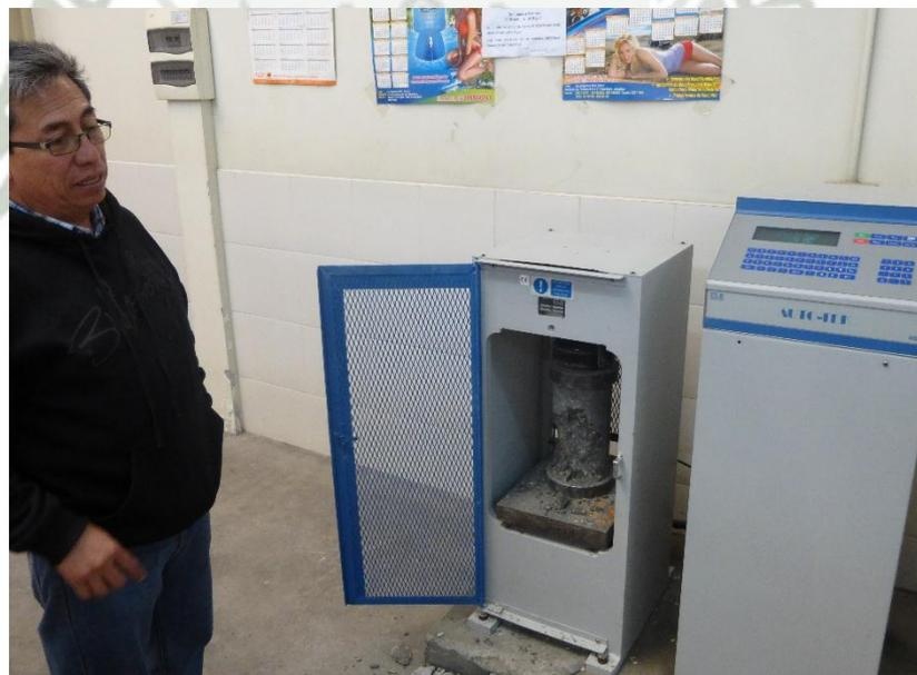
Fotografía 18: Ensayo a la resistencia de compresión para las probetas de 6 x 12 pulgadas.
