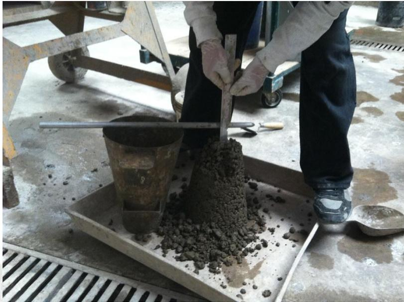
*Fotografía 07: Verificando el slump del concreto patrón.*
