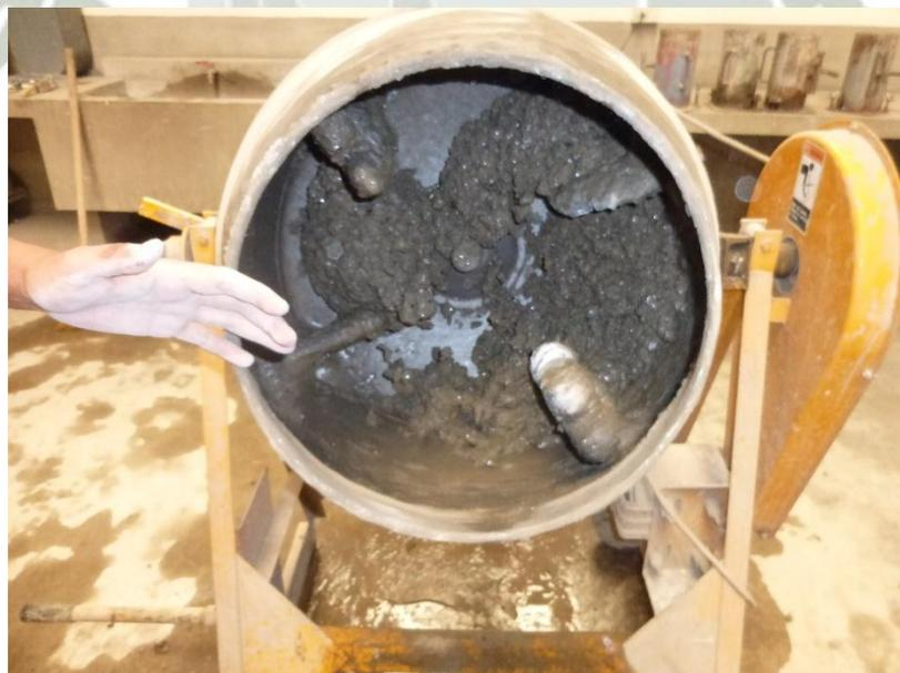
*Fotografía 08: Diseño de mezcla del concreto con influencia de la microsílíce y superplastificante.*
