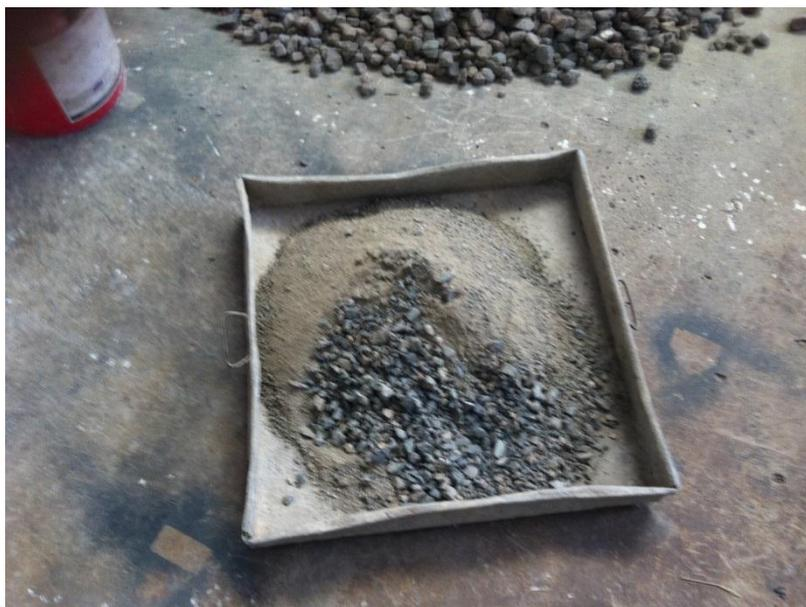
*Fotografía 03: Método del cuarteo para el ensayo de máxima compacidad.*
