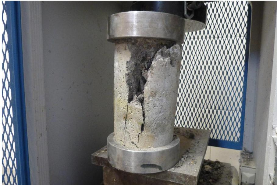
*Fotografía 23: Imagen de la probeta de alta resistencia a la compresión,
