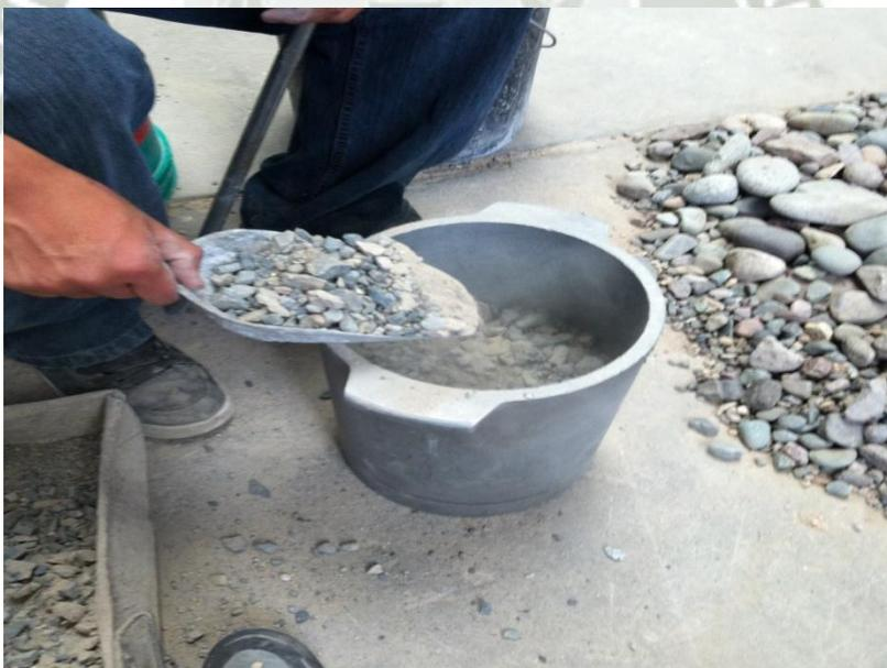
*Fotografía 04: Realizando el método de peso unitario varillado para hallar la máxima compacidad según el porcentaje de agregados finos y gruesos mezclados.*
