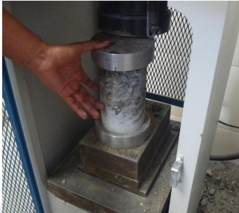
Fotografía 13: Ensayo a la resistencia de compresión para las probetas de 4 x 8 pulgadas.
