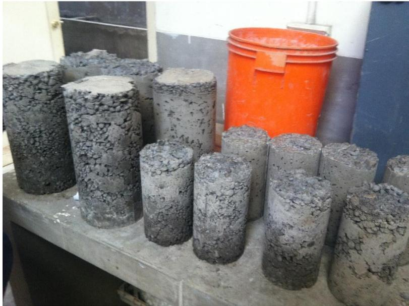
Fotografía 11: Concreto patrón  $F'c = 800 \text{ kgf/cm}^2$  después de desencofrar.
