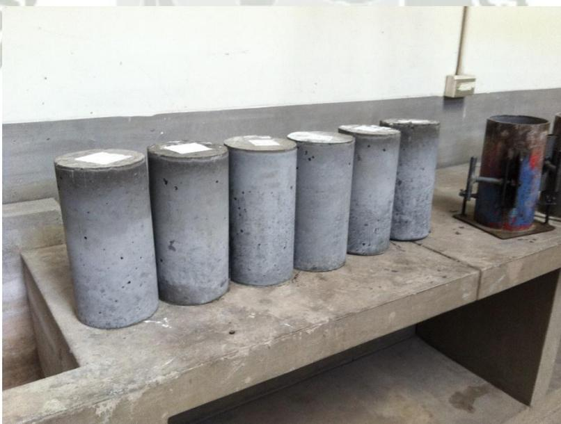
*Fotografía 10: Probetas con microsílíce y superplastificante después de desencofrar.*
