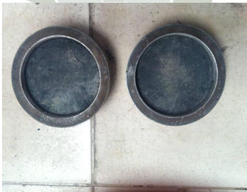
*Fotografía 02: Platos de retención de acero para refrentado de probetas de 4 pulgadas.*
