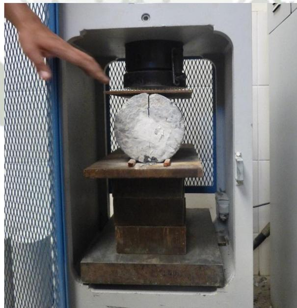
Fotografía 20: Ensayo de tracción indirecta para las probetas de 6 x 12 pulgadas, Método Brasileiro.
