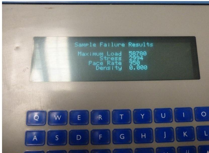
Fotografía 17: Máxima fuerza a la compresión de la probeta de 4 x 8 pulgada, Método de ACI, "Concreto Patrón".
