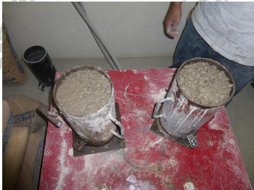
Fotografía 12: Probetas en la mesa vibradora con relación a/c muy bajas.
