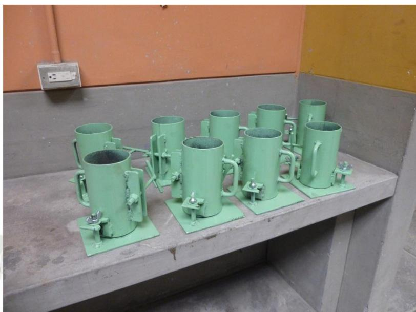
*Fotografía 01: Briquetas de 4 pulgadas de diámetro por 6 pulgadas de altura.*
