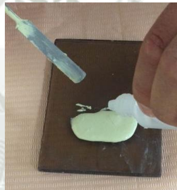
MEZCLA FINAL CON MEC
