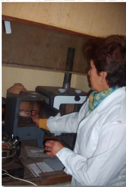
Foto 11. Muestras de biomasa de las diferentes partes vegetativas(raiz, tallo, hojas e inflorescencia) colocadas al horno para la incineración
