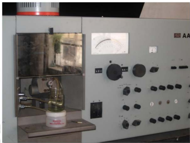
Foto 14; Espectrofotómetro de Absorción Atómica Marca(CARL ZEISS. JENA - AAS1N)
