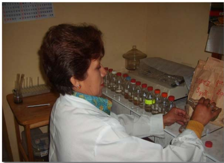
Foto 12. Muestras debidamente diluidas con el ácido nítrico para su posterior lectura en el EAA
