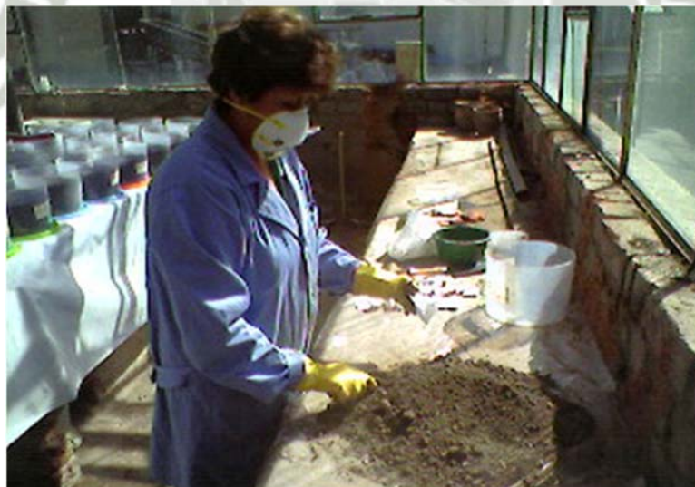
Foto 2. Proceso de contaminación del suelo con las diferentes concentraciones de plomo
