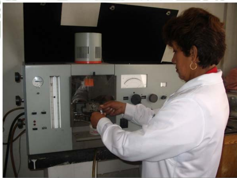
Foto 14; Espectrofotómetro de Absorción Atómica Marca(CARL ZEISS. JENA - AAS1N)
