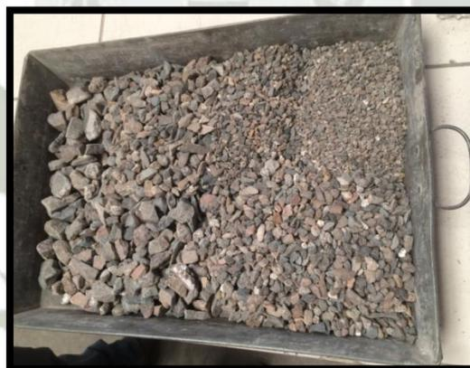
Figura 15. Muestras retenidas en mallas - agregado grueso 3/4".
