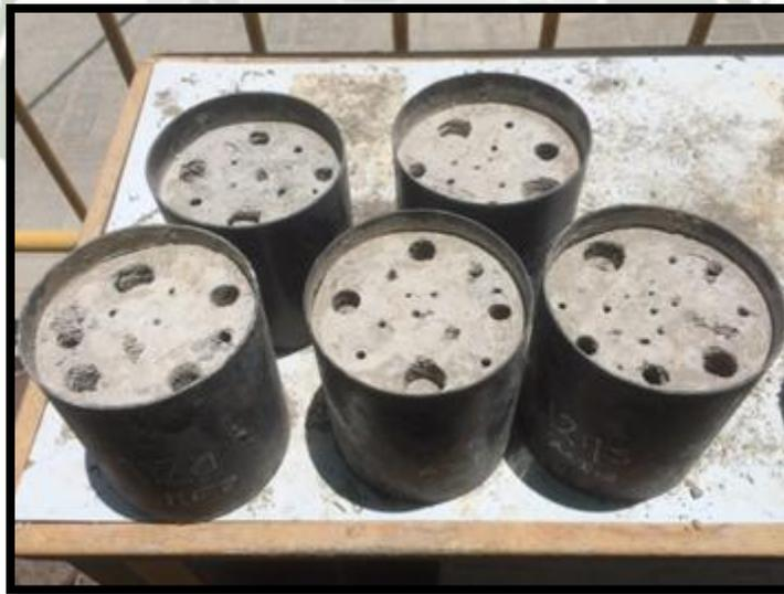
**Figura 5. Moldes ensayados para tiempo de fraguado.**
