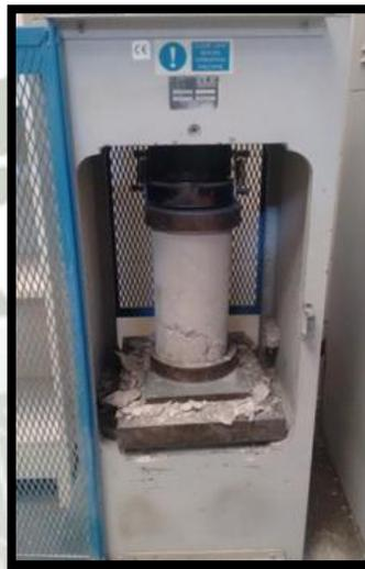
**Figura 9. Ensayo de testigo de concreto a compresión.**
