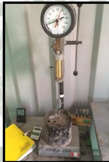
Figura 6. Ensayo de tiempo de fraguado con Penetrómetro.
