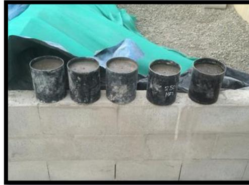
**Figura 8. Moldes llenos con mezcla tamizada para realizar el ensayo.**
