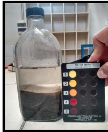
Figura 14. Comparación de la muestra con el patrón Gardner.
