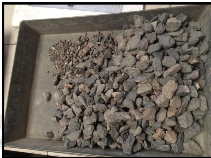
Figura 16. Muestras retenidas en mallas - agregado grueso 1".
