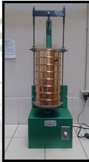
Figura 12. Máquina tamizadora de agregado fino
