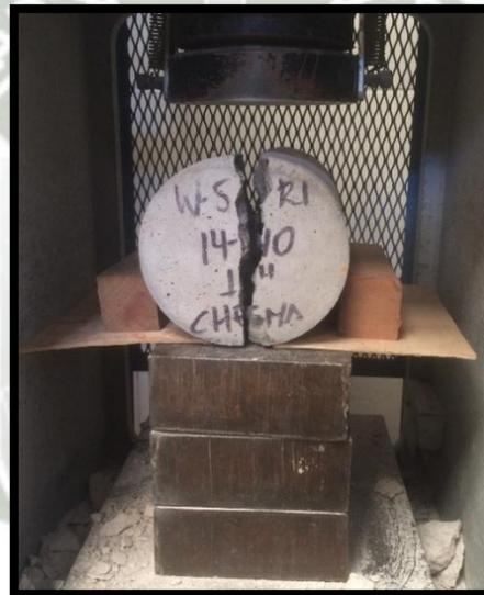
Figura 11. Ensayo de testigo de concreto a tracción indirecta.
