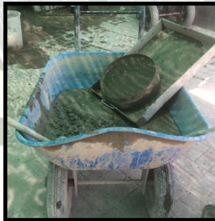
Figura 7. Tamizado de la mezcla por la malla #4.
