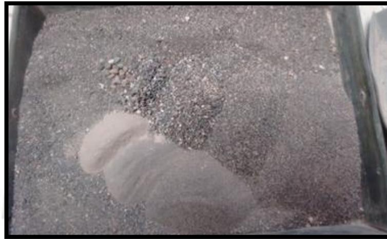
Figura 13. Muestras retenidas en mallas - agregado fino.
