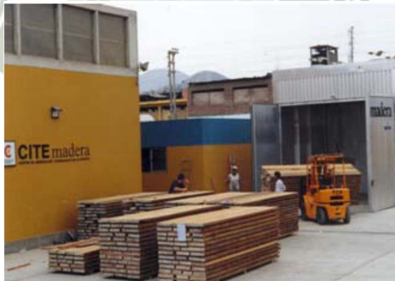
FIGURA N° 4-1.- CARGA DE MADERA DE LA MISMA ESPECIE Y ESPESOR LISTOS PARA INGRESAR AL HORNO SECADOR
