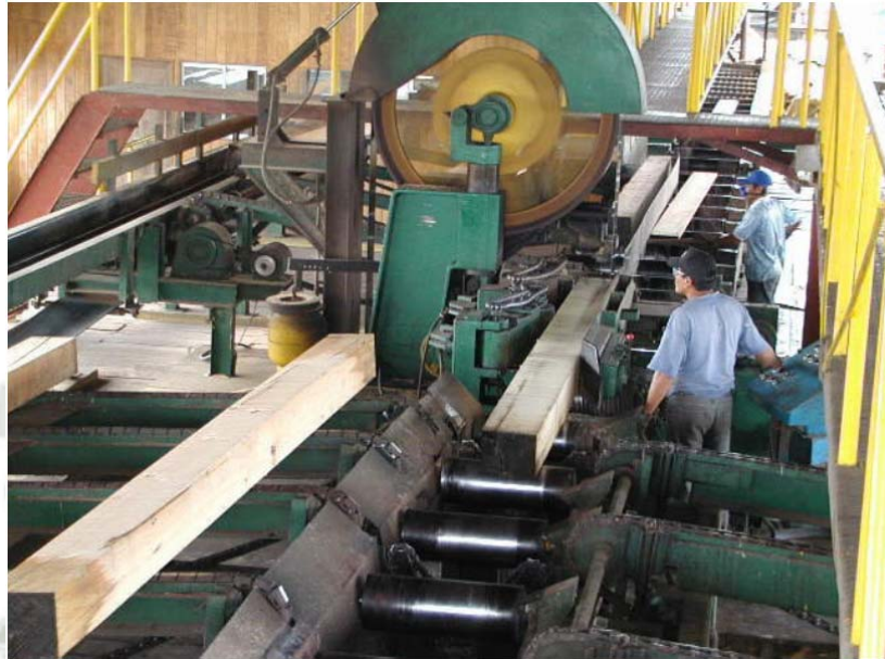
FIGURA N° 4-3.- SIERRA CINTA TABLEANDO FLITCHS
