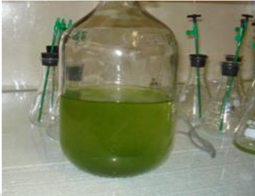
2L de inoculo de Chlorella vulgaris antes de su transferencia a fotobioreactor en panel.
