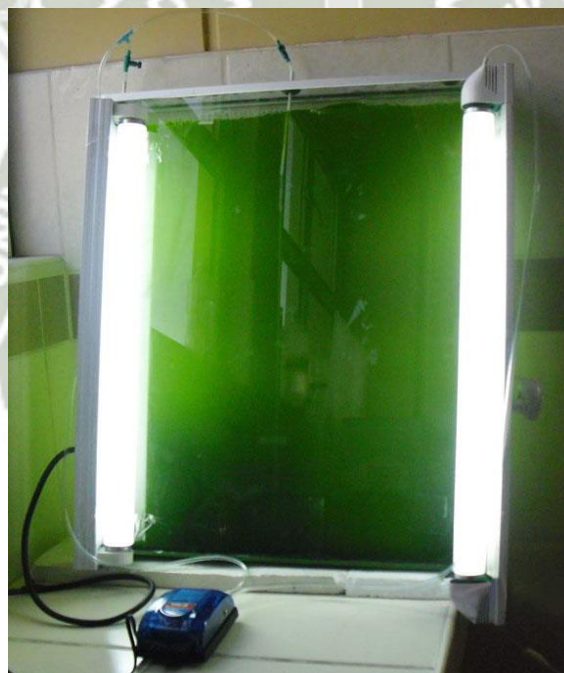
Figura 11. Mantenimiento del cultivo y evaluación del crecimiento de Chlorella vulgaris en condiciones controladas de fotobioreactor tipo panel
