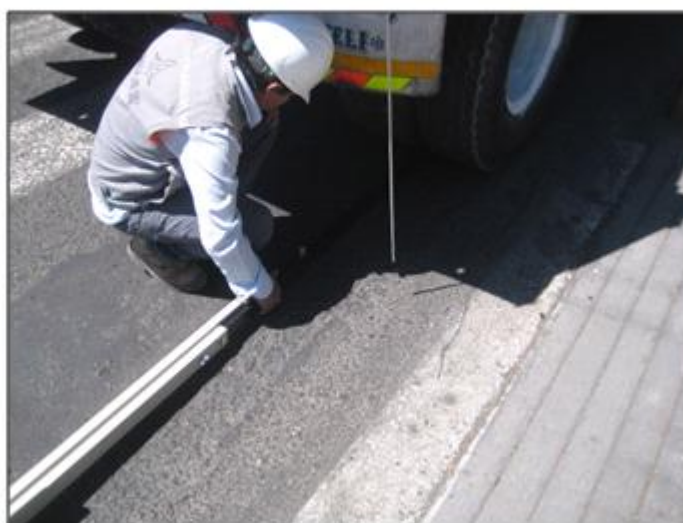
Foto. 3.2 Posicionamiento de viga al eje de las ruedas del camión
