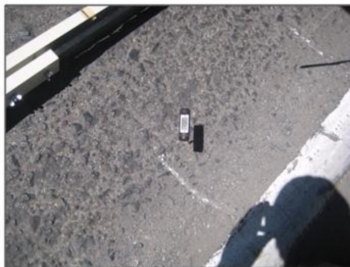
Foto 3.4 Medición de temperatura del pavimento.
