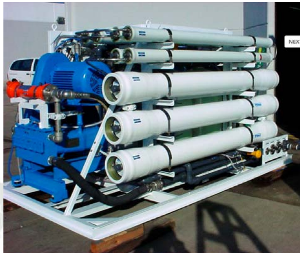
Figura 13: Equipo de Osmosis Inversa
