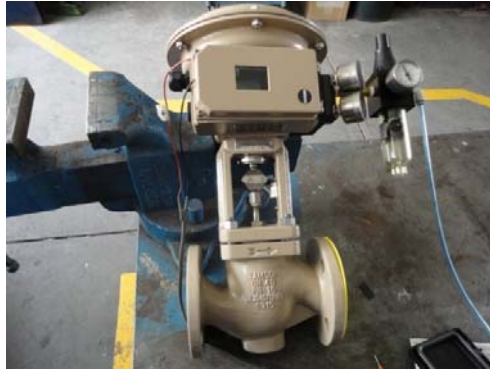
Figura 109: Calibración de la válvula Proporcional de Ingreso Vapor
