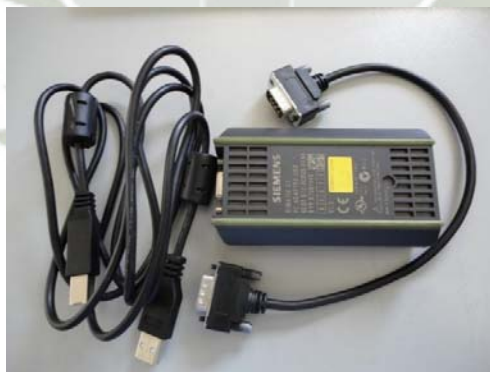
Figura 112: PC Adapter, para programar el PLC
