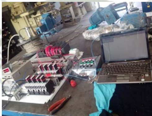
Figura 111: Descarga del Programa hacia el PLC S7-300
