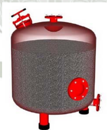
Figura 9: Filtro de Carbón Activado
