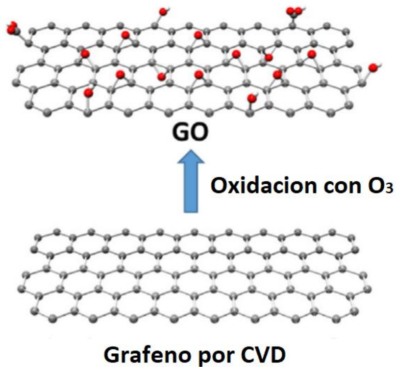
Figura 2- 16: Preparación de óxido de grafeno a partir de grafeno Fuente: (Kei Toda, 2015)
