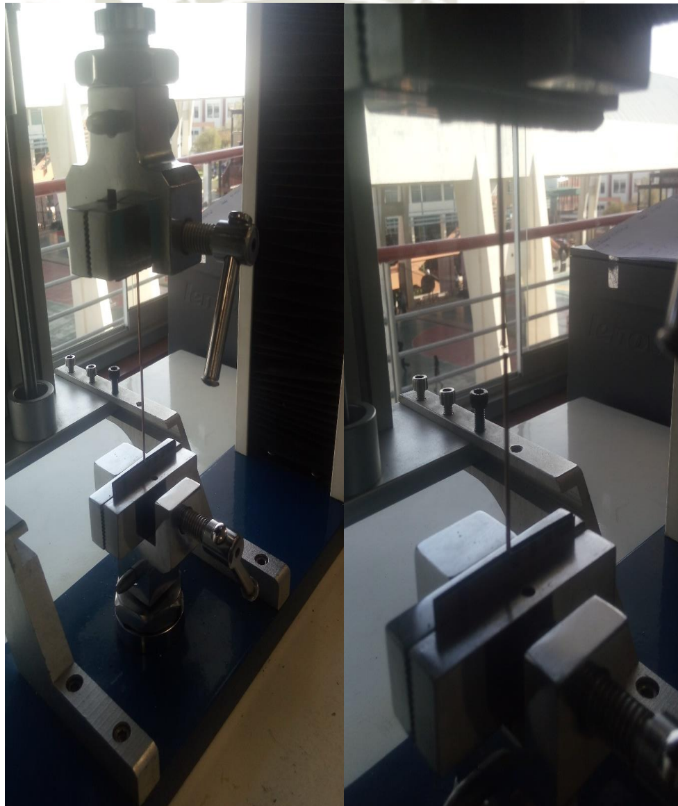
Figura 3 - 14: Ensayo de tracción Fuente: Elaboración propia
