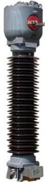
Figura 14.- Transformador de corriente.- Los núcleos y los devanados secundarios se encuentran dentro de la cabeza del transformador. El aislamiento total de la alta tensión se consigue con el gas SF6, en lugar de papel-aceite.
