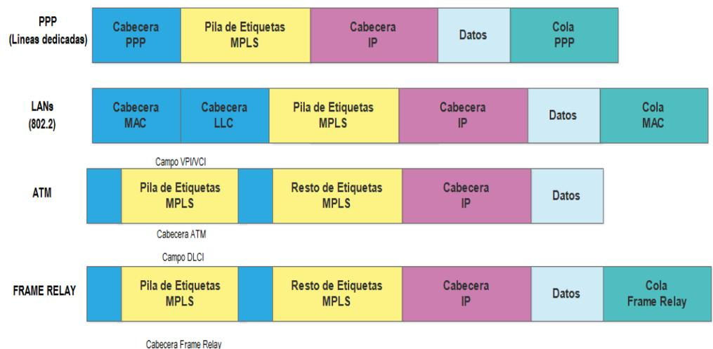
**Gráfico N° 5. Encapsulación ATM, PPP, IEE 802 y Frame Relay**
