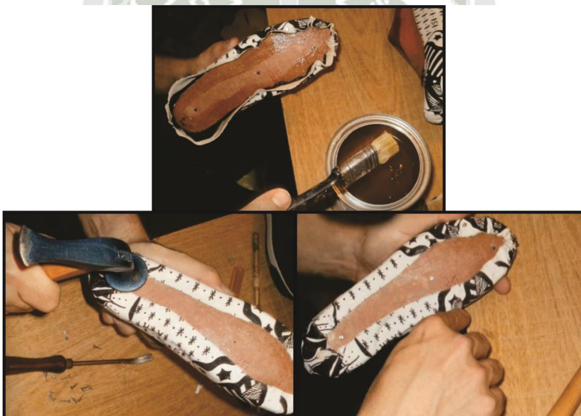
Figura N°150: Unión de capellada y falsa de la balerina con pegamento
