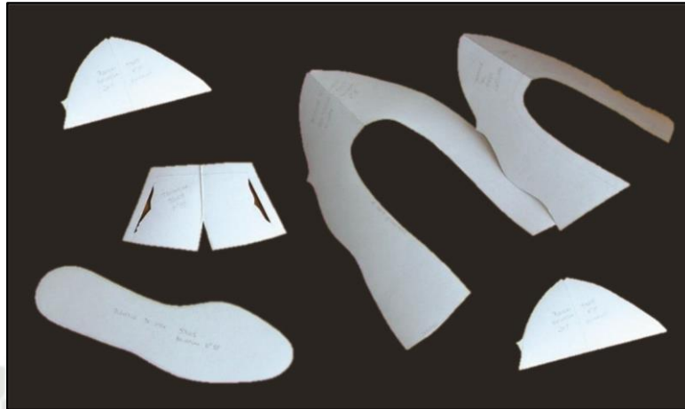
Figura N°168: Molde para Balerinas
