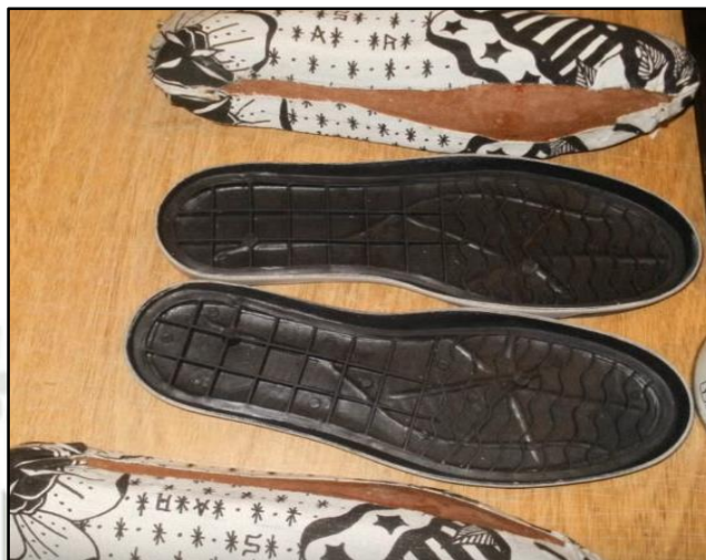
Figura N°151: Unión de piezas de la misma talla para pegado de la suela
