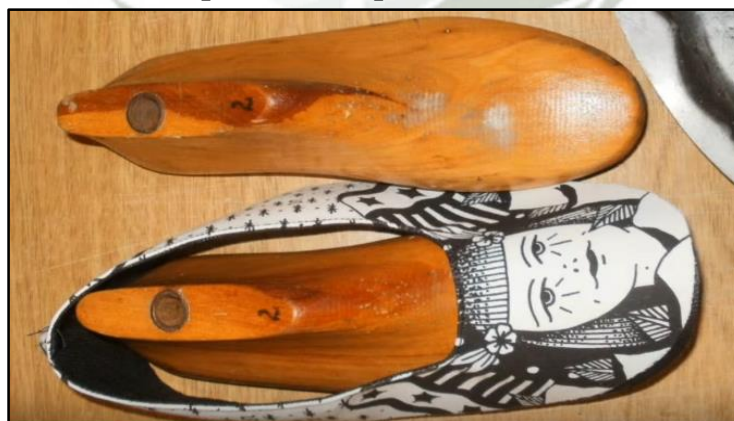
Figura N°148: Capellada lista para tomar forma de la horma
