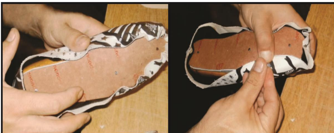
Figura N°149: Unión con clavos de la capellada y falsa de la balerina
