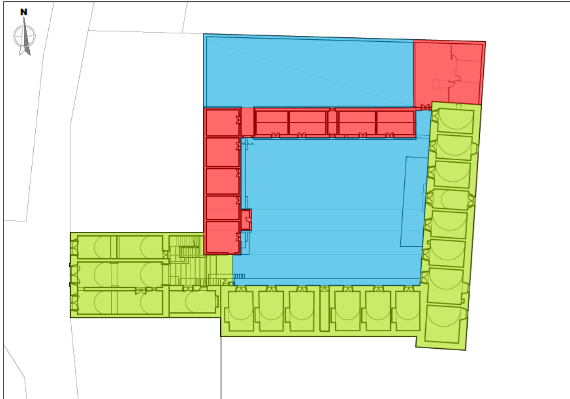
Figura 52.- Plano de propuesta 1 - DEMOLICIONES
