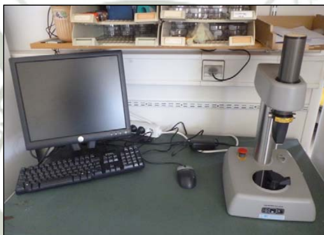
Figura 36. Penetrómetro marca Fruit Texture Analyzer utilizado en la determinación de la dureza de los frutos de Solanum lycopersicum (tomate) 'Micro-Tom'.
