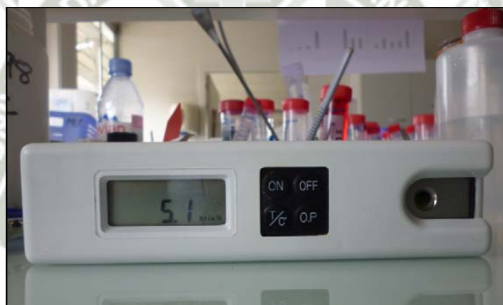
Figura 38. Refractómetro digital Euromex utilizado en la determinación del contenido de sólidos solubles de los frutos de Solanum lycopersicum (tomate) 'Micro-Tom'.
