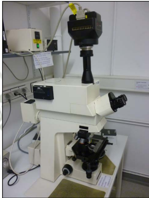
Figura 16. Microscopio Zeiss Axiophot y cámara SPOT RT3 para la adquisición de imágenes de cortes de pedicelo.
