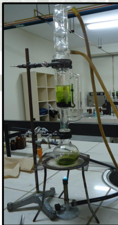
Figura N° 7: Extracción de Soxhlet
