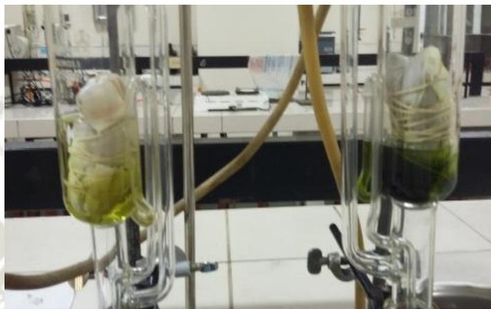
**Figura N° 6: Extracción de las plantas en equipo Soxhlet**
