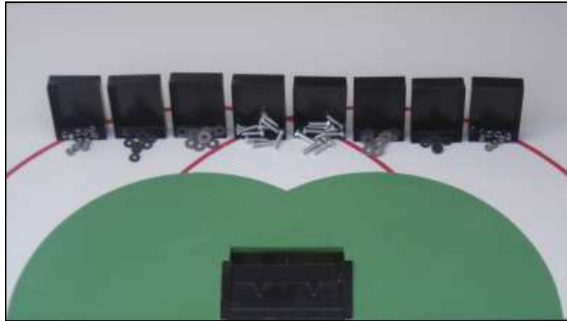
Foto N° 26: Método antiguo de montaje (depósitos parados)
