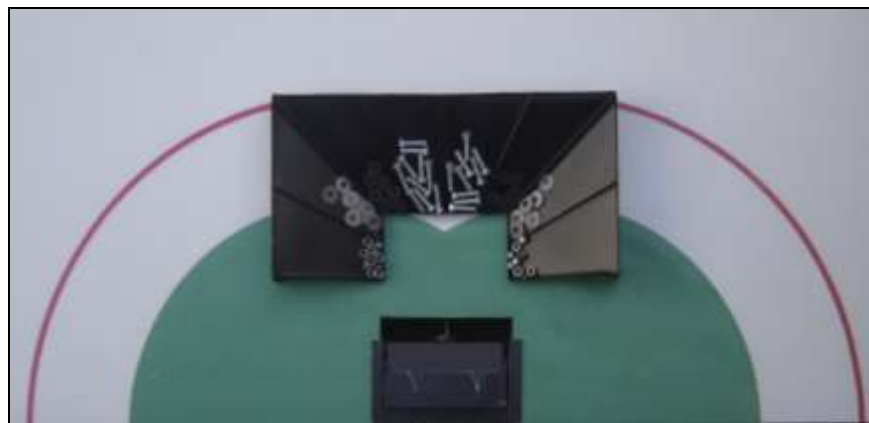
Foto N° 27: Depósito de arandelas
