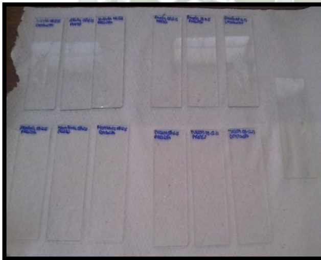
Foto 20: Portaobjetos donde se procede a realizar el extendido para posteriormente poder observar los cristales.
