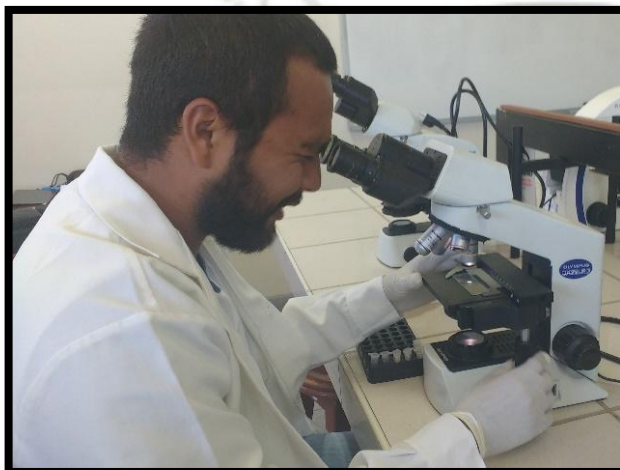
Foto 25: 3° Dejamos secar a temperatura ambiente por un promedio de 15 minutos y observamos al microscopio.
