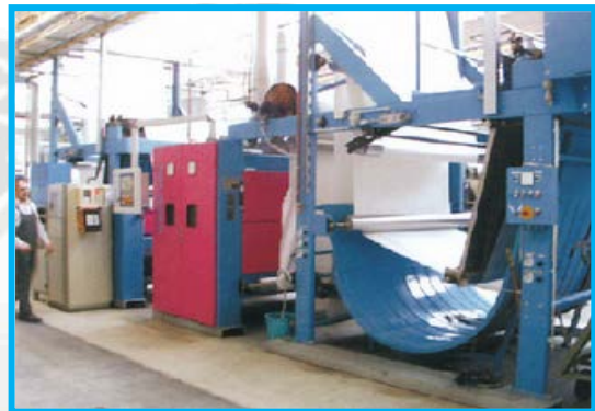
ILUSTRACIÓN N° 18: CHAMUSCADO O QUEMADO
