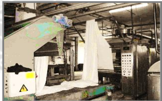
ILUSTRACIÓN N° 19: DESENCOLADO O DESENGOMADO
