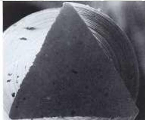
**Figura Nº 23:** Fotomicrografía de corte transversal del ensanchador 150X
