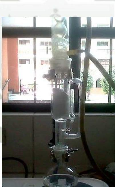
**Figura N° 9: Equipo Soxhlet.**
