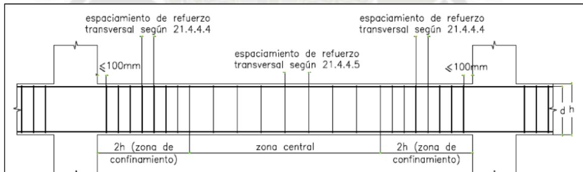
FIGURA N°48 Requerimientos de Estribos en Vigas.
