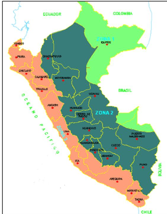
FIGURA N°35 Zonas Sísmicas según la Norma E.030.
