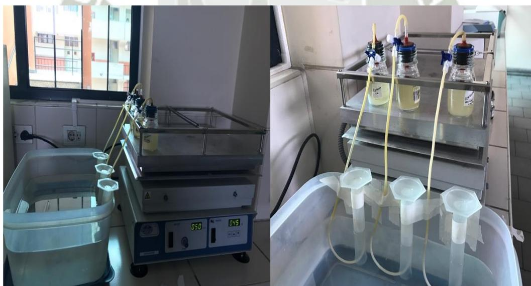
**Figura 21. Sistema para la medición de la producción de biogás.**
