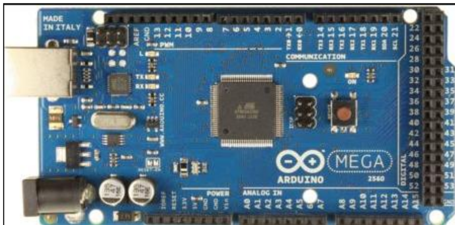
Figura 3: Placa Arduino Mega basada en chip Atmega 2560.
