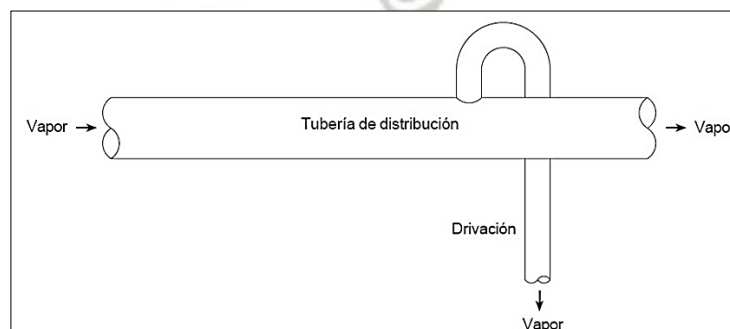
Ilustración II-7 Derivación tubería principal (Spirax Sarco)
