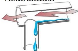
Figura 16-1. Especificación de las Piernas Colectoras
