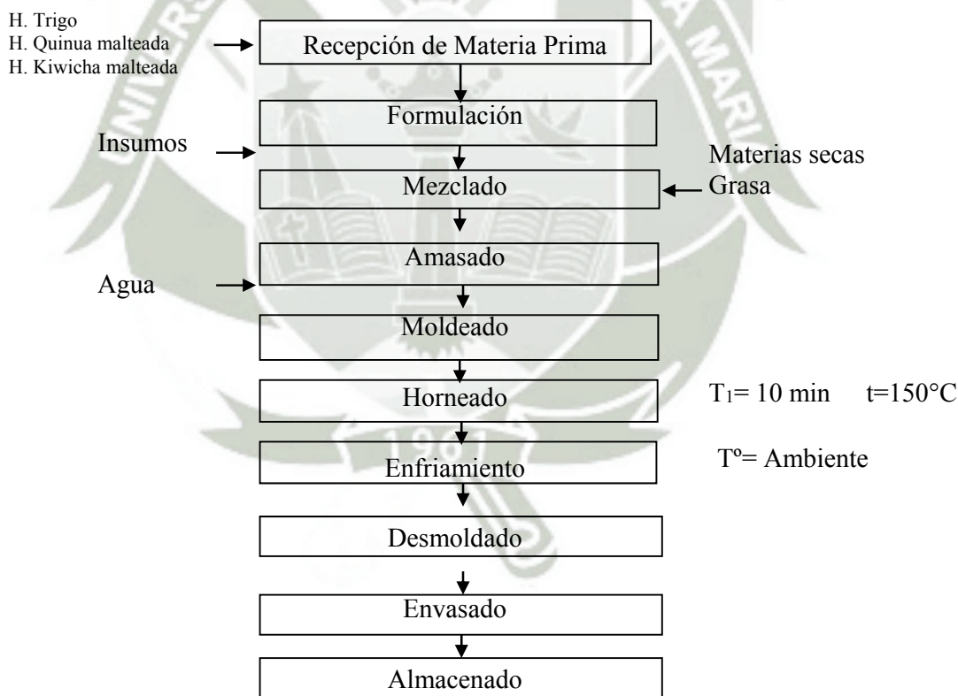
Diagrama de Bloques Elaboración de Galletas Con Premezcla
