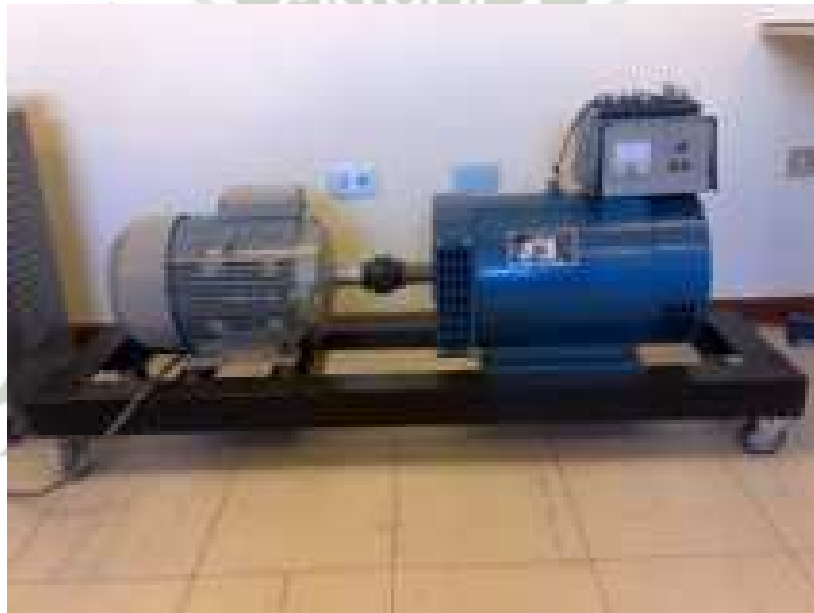
Fig. 2.62: Módulo alternador-motor asíncrono
