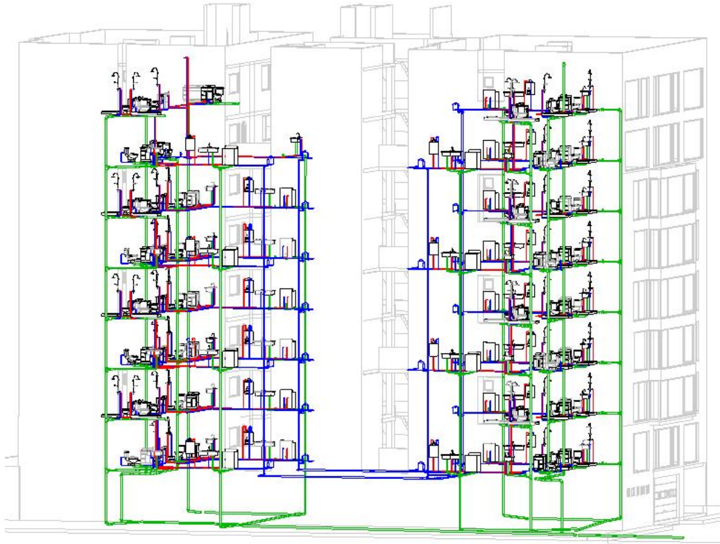
Figura 3.24: Modelo Instalaciones Sanitarias
