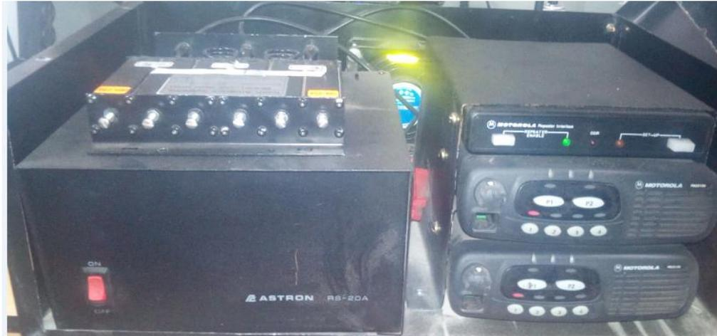
**Figura 3.33. Repetidor Analógico.**
