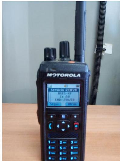
**Figura 3.47. Equipo suscriptor portatil con nivel de RSSI.**
