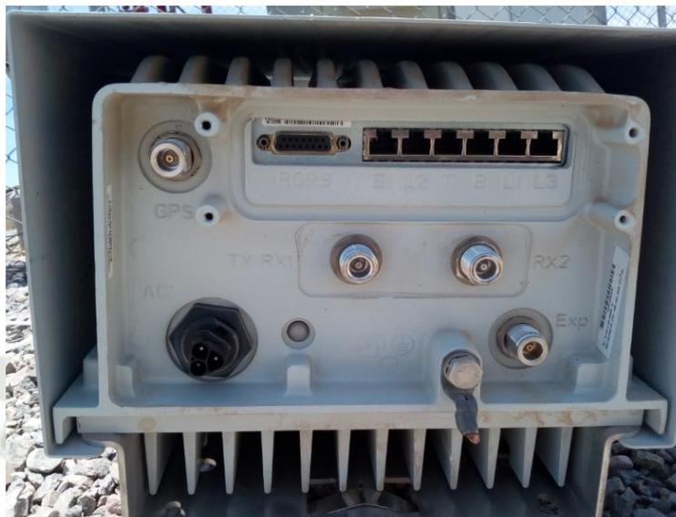
**Figura 3.57. Vista de Terminales de Estación Base MTS1.**
