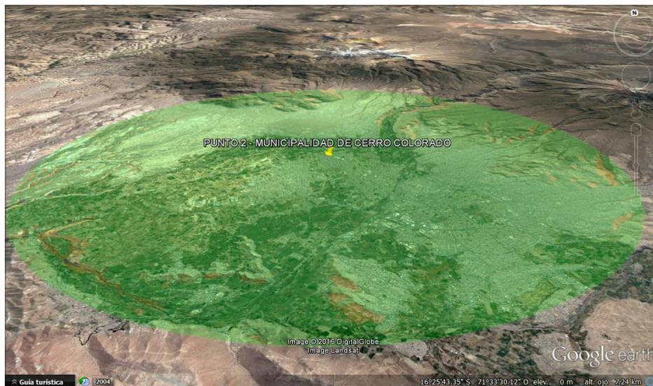
**Figura 3.18. Propagación de Señal de Estación Base Municipalidad de Cerro Colorado.**
