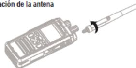
Apague la radio antes de colocar la antena. Alinee la parte inferior de la antena y la base roscada de la parte superior del radio. Gírela hacia la derecha hasta que quede ajustada. No la fuerce.
