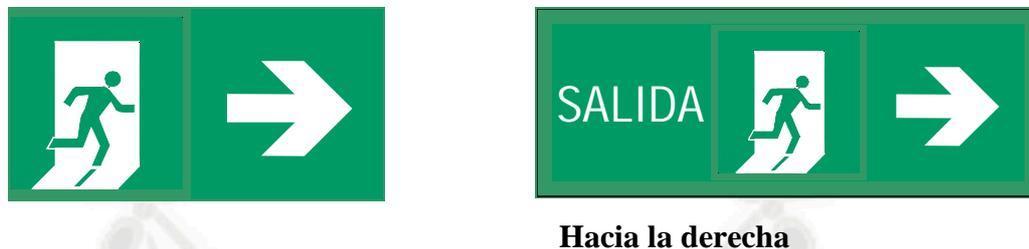
**FIGURA 13 - Ejemplos de señales combinadas con la flecha direccional a la derecha**
