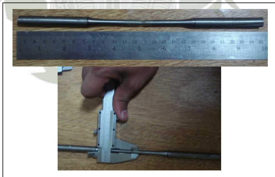
Grafico 52: Probeta Ensayo de Tracción Norma A370 Medidas.
