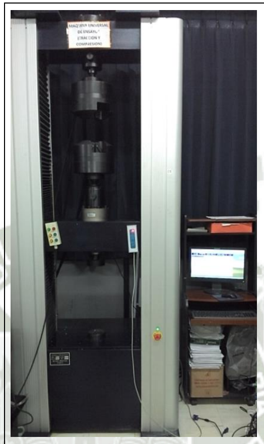
Grafico N° 39: Maquina Universal de Ensayo de Tracción y Compresión Modelo WDW – 300E
