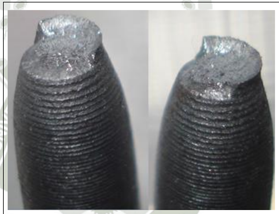
Grafico N° 68 : Ensayo a Tracción / Fractura Parcial de Taza y Cono.
