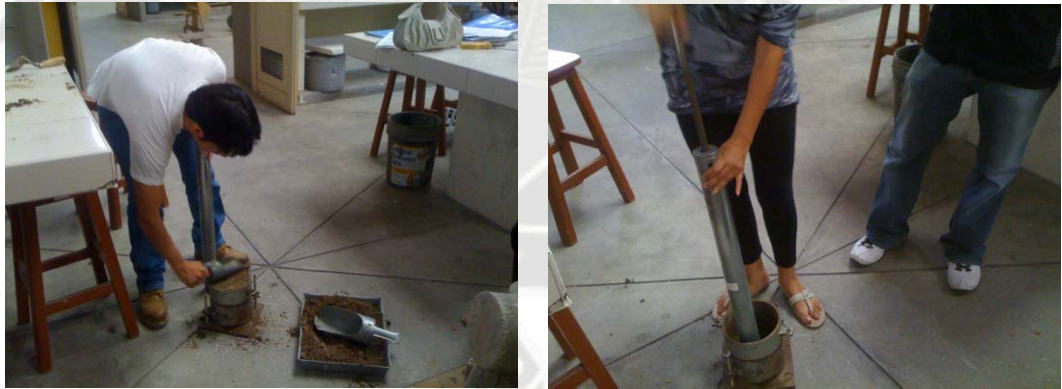
Foto 06: Ensayo de Compactación Proctor Modificado.
