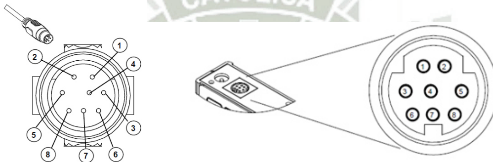
Figura 34: Cable de Salida MiniDIN 8 y Entrada estándar MiniDIN 8 Fuente: (Alicat, Operating Manual - Precision Gas Mass Flow Controllers, 2016)
