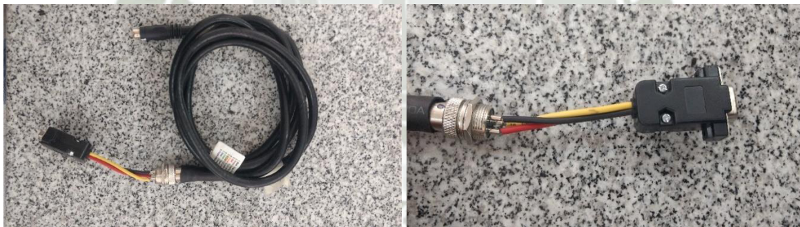
Figura 36: Conversión MiniDIN 8 a conector DB9 Hembra Fuente: Elaboración Propia
