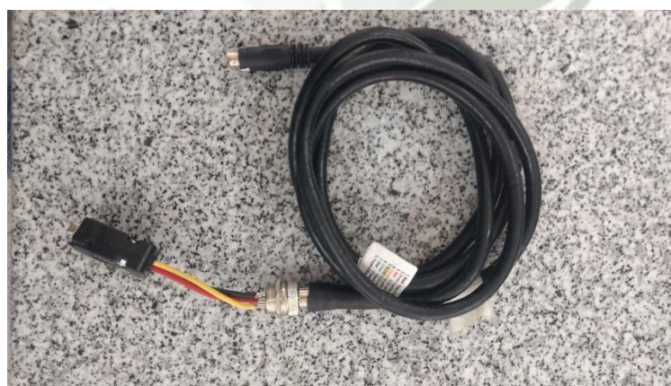
Figura 30: Estándar MiniDIN 8 a DB9 Fuente: Elaboración Propia
