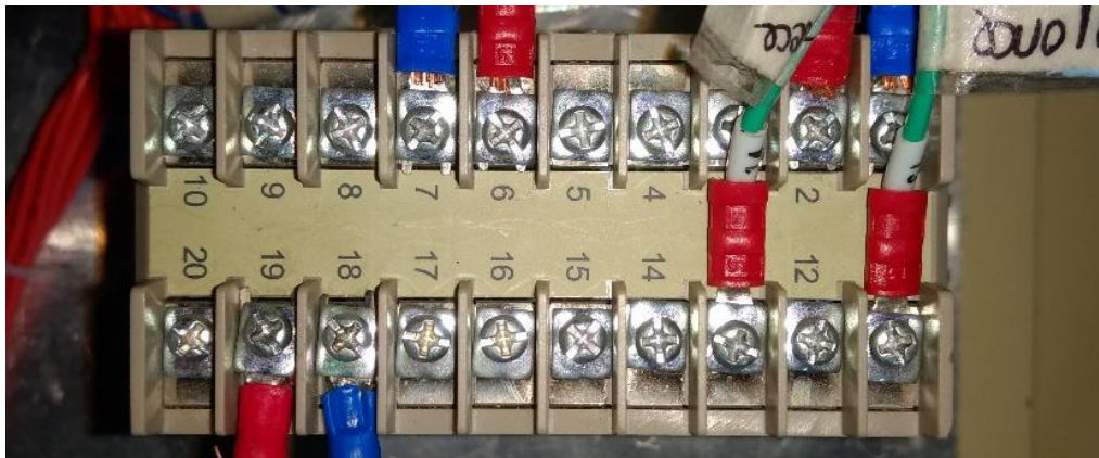
Figura 42: Entradas y salidas del controlador Yudian Fuente: Elaboración Propia
