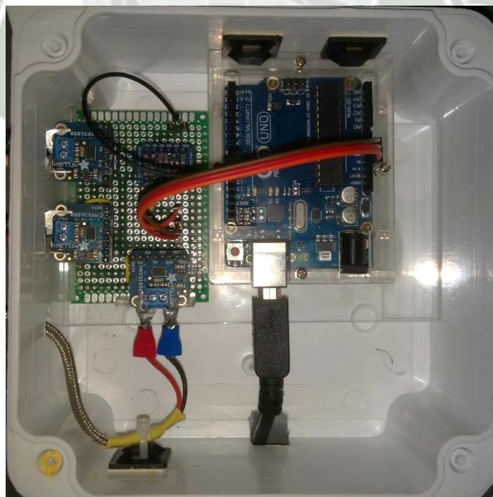
Figura 53: Módulo de Comunicación del Subsistema de termocuplas auxiliares Fuente: Elaboración Propia
