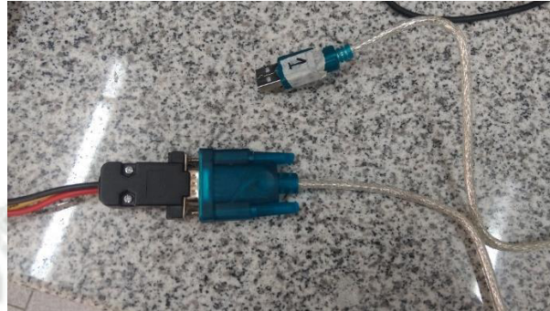
Figura 37: DB9 a Salida USB Comunicación RS-232 Fuente: Elaboración Propia
