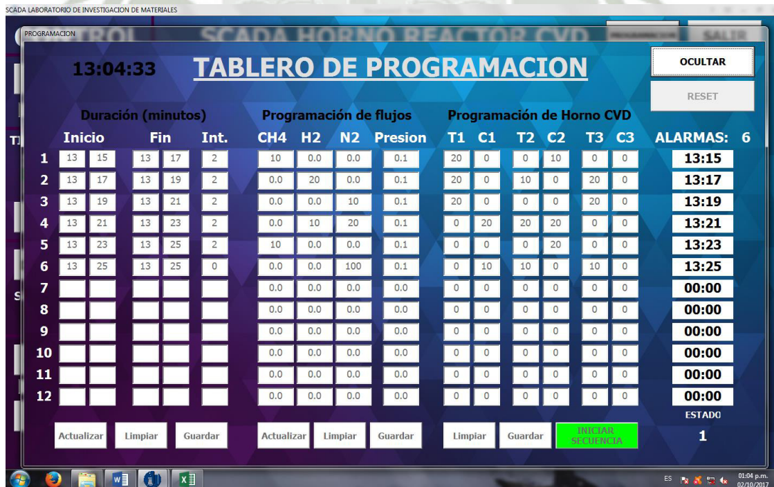
Figura 35: Al iniciar secuencia se muestra las alarmas y el estado que esta por empezar.
