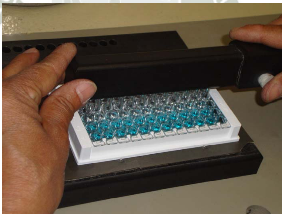
FOTO N° 16: LAVADO DE LOS POZOS
