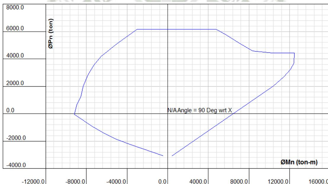
**Figura 6.19.** Diagrama de interacción a 90° obtenido de la sección.
