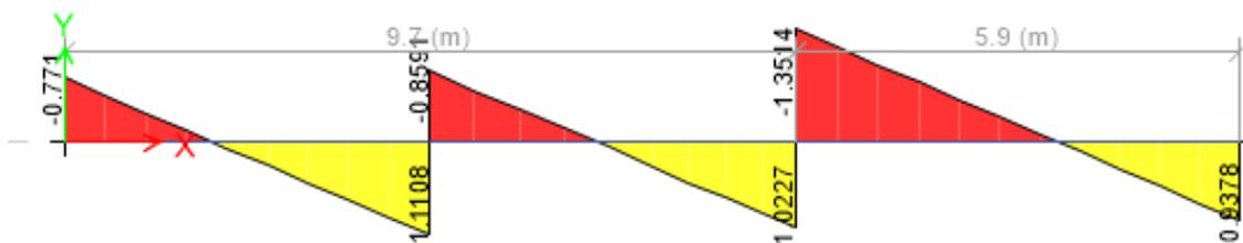
**Figura 5.2.** Valores de las cortantes obtenidas del ETABS.
