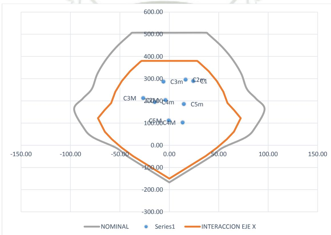
**Figura 5.23.** Diagrama de interacción en el sentido Y-Y.
