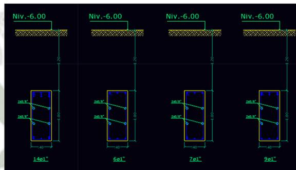
**Figura 5.49.** Detalle de acero de vigas de cimentación.
