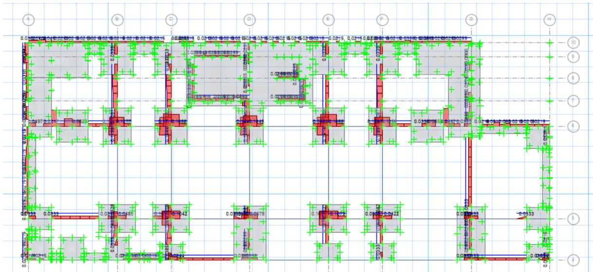
**Figura 5.48.** Gráfico de cortantes de las vigas de cimentación.
