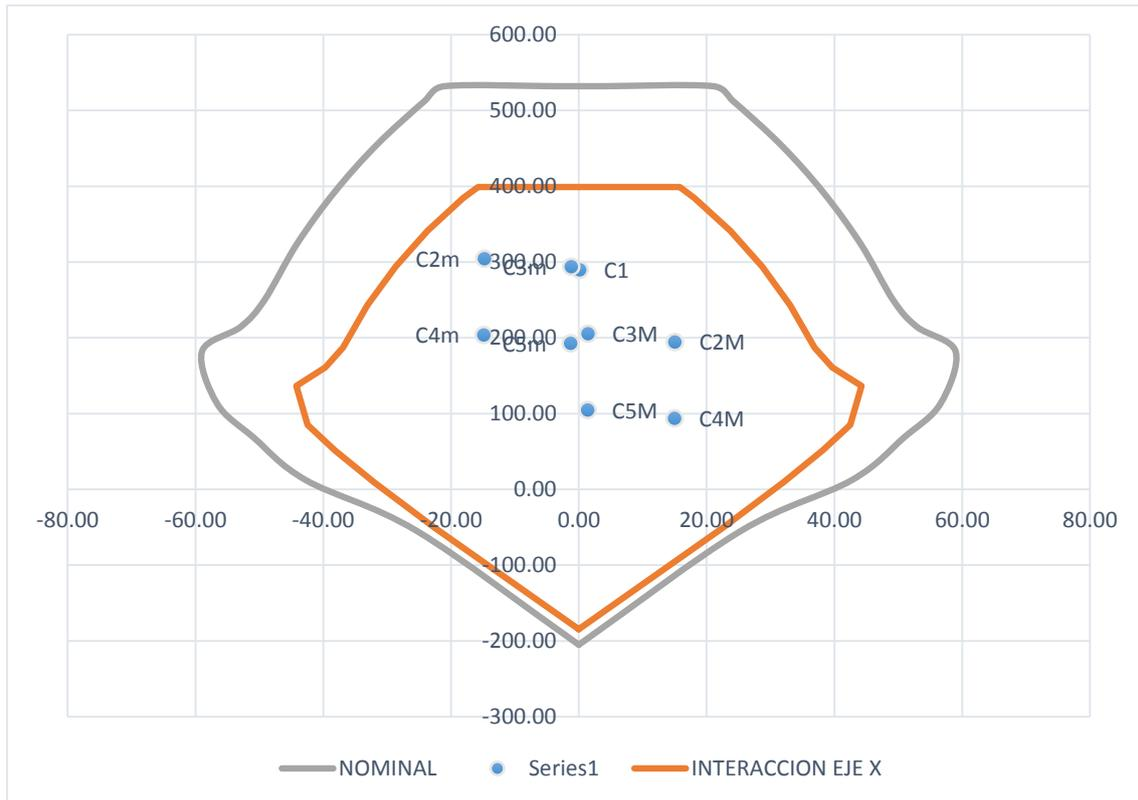
**Figura 6.13.** Diagrama de interacción en el sentido X-X.
