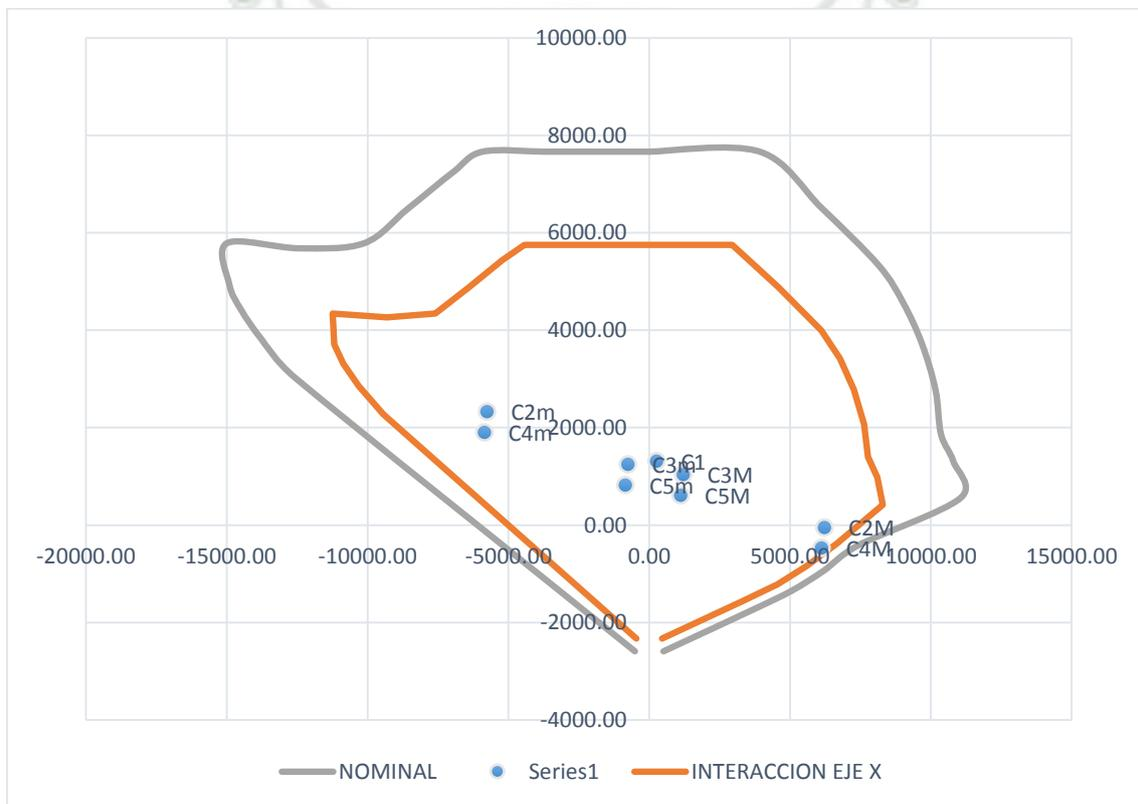
**Figura 5.33.** Diagrama de interacción en el sentido X-X a 90°.
