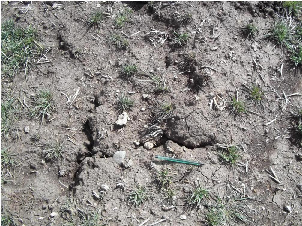
Figura 8. Detalle de agrietamientos ocurridos en la zona de influencia de la calicata C1 (debido a la existencia de la laguna de oxidación existente).
