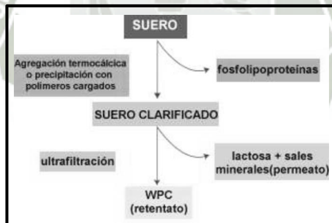
Gráfico N° 3: Fraccionamiento del suero lácteo.
