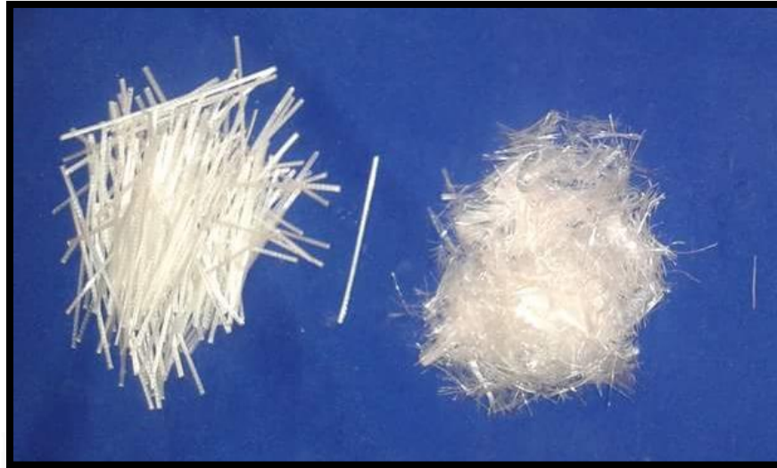
FIGURA 2.8 Distintas fibras de polipropileno usadas en la presente investigación
