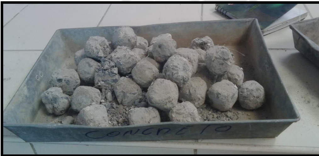
FIGURA 5.9 Las muestras se pesan después del ensayo
