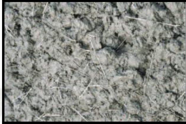
FIGURA 2.7 Fibras de acero mezcladas con hormigón
