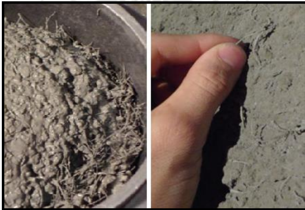
FIGURA 2.1 Concreto Fresco y Concreto Endurecido
