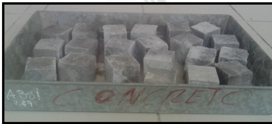
FIGURA 5.8 Muestras de cubos de concreto
