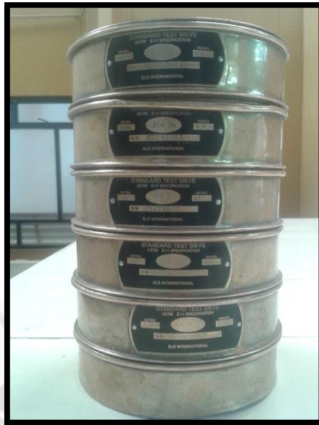
FIGURA 3.1 Tamices utilizados para el agregado grueso
