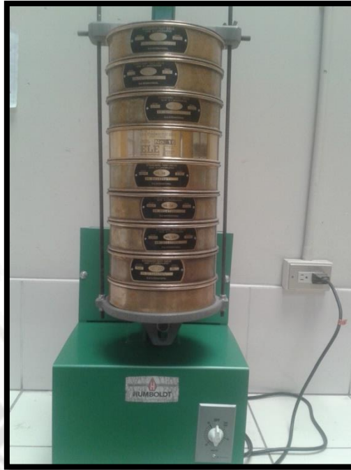
FIGURA 3.4 Tamizadora mecánica y tamices para agregado fino
