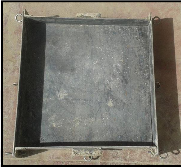
FIGURA 5.3 Molde de fisuración 35 x 35 x 5 cm
