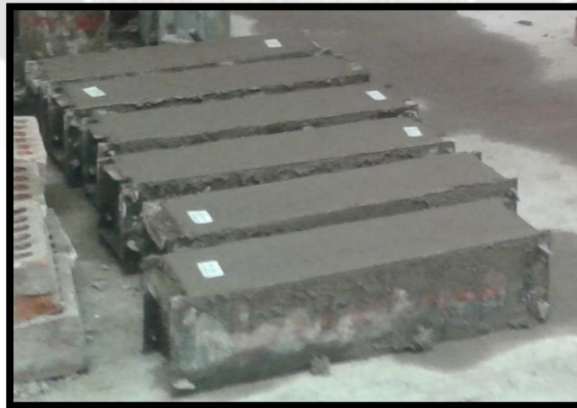
FIGURA 6.7 Vaciado de probetas prismáticas en moldes
