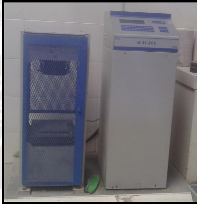
FIGURA 5.5 Máquina de ensayo a la compresión del concreto
