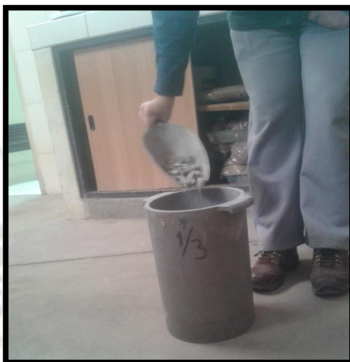
FIGURA 3.3 Ensayo de P.U. del agregado grueso
