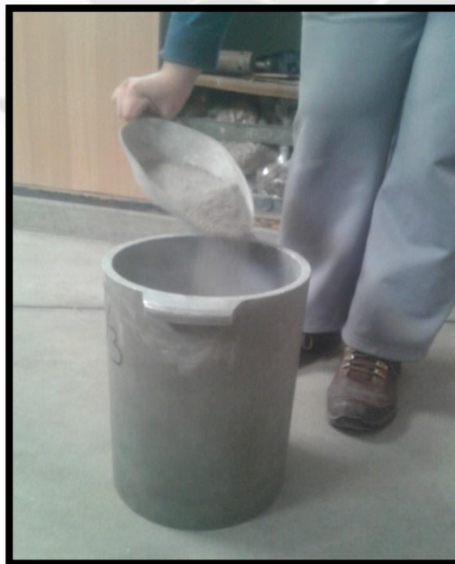
FIGURA 3.7 Ensayo del P.U. del agregado fino
