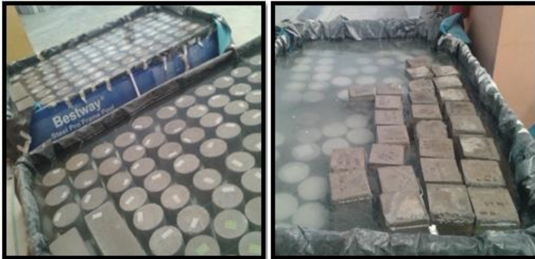
FIGURA 6.8 Pozas de curado conteniendo probetas cilíndricas y prismáticas
