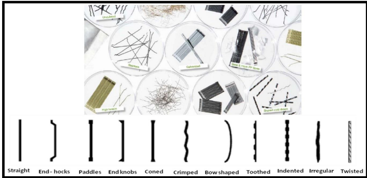
FIGURA 2.6 Distintas presentaciones de la fibra de acero en el mercado
