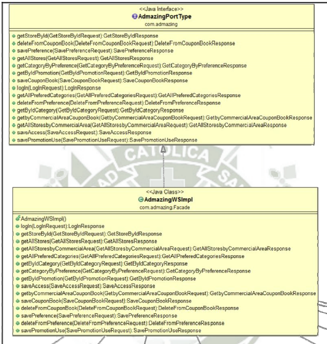
Figura 22: El patrón Fachada dentro del diagrama de clases del web service.
