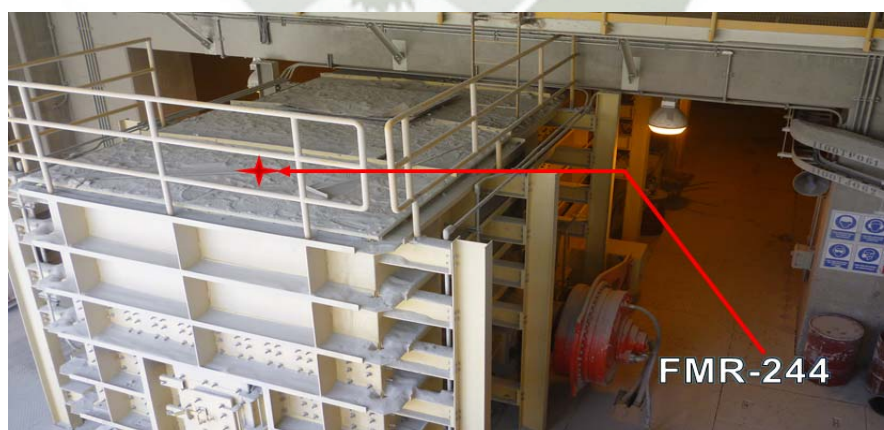
Figura 3.1.16: Fotografía Apron Feeder – Edificio de Chancado; Ubicación de Montaje del Transmisor Tipo Radar E&H FMR-244
