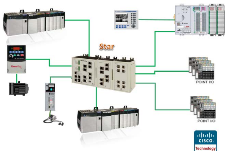
Figura 2.2.11: Esquema de conexión Ethernet tipo Estrella. Fuente:[Referencia Electrónica]
