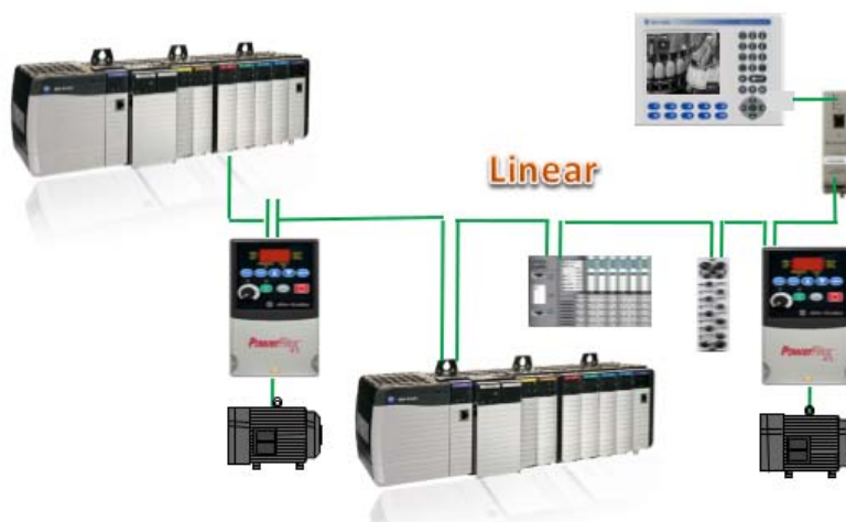
Figura 2.2.12: Esquema de conexión Ethernet tipo Linear. Fuente:[Referencia Electrónica]
