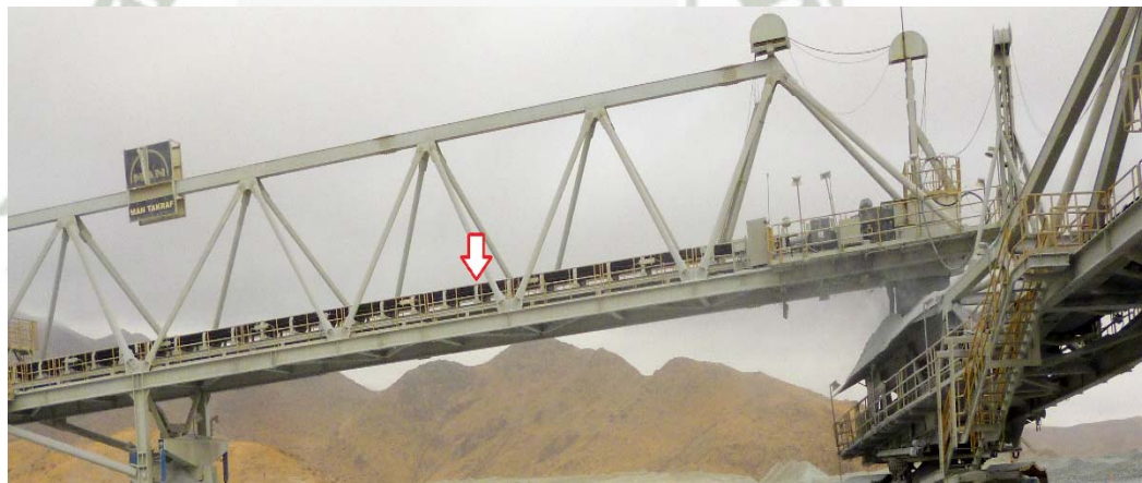
Figura 3.1.7: Fotografía Cabeza de Faja – Ubicación de Celda de Carga A 18
