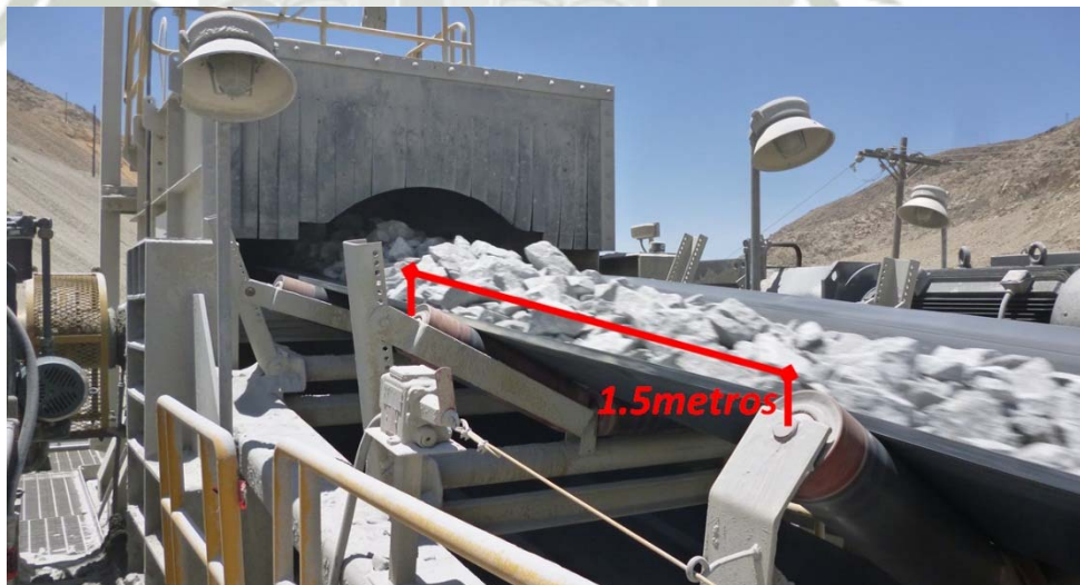
Figura 3.1.2: Fotografía Cabeza de Faja - Espacio entre Polines 1.5metros.
