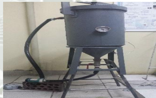
Foto 23: Reactor usado para el proceso de transesterificación.
