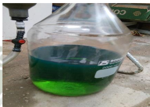
Foto 30: Biodiesel purificado para su caracterización y prueba en el motor.
