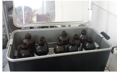
Foto 21: Uso de baño maría a 80°C para eliminar el exceso de los solventes.
