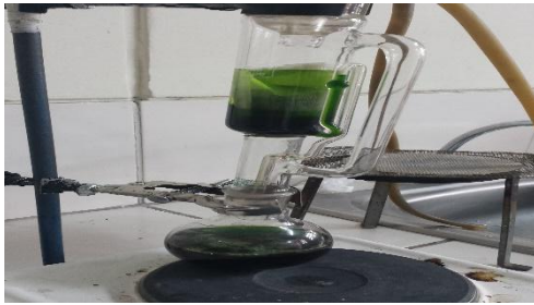
Foto 17: Proceso de extracción de aceite del alga en el equipo Soxhlet.
