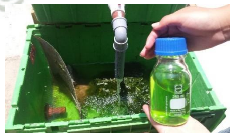
Foto 8: Suplementación con medio de cultivo en el sistema de flujo.
