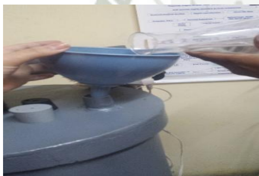
Foto 27: Adición del betóxido de K al interior del reactor para el inicio de la transesterificación.
