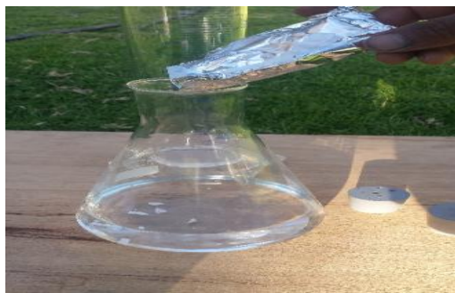
Foto 25: Mezcla del metanol y el KOH para la formación de betóxido de K.
