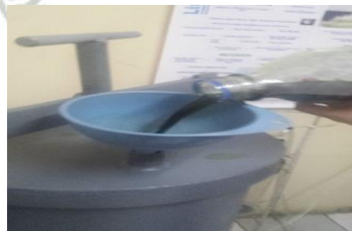
Foto 24: Adición del aceite al interior del reactor.
