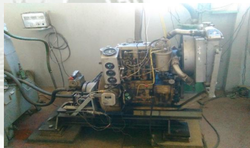
Foto 31: Motor petrolero de 4 tiempos de la Facultad de Mecánica de la UNSA, para los ensayos del Biodiesel.
