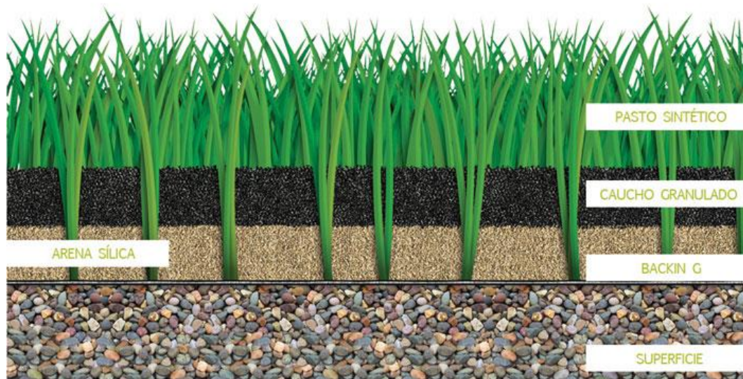
Ilustración 13. Extractos de materiales para la instalación de Grass sintético.
