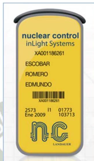
Fig. 5. Dosimetro captador de radiaciones tipo Inlight Systems recomendado para uso del personal técnico, operadores, y docentes expuestos frecuentemente a radiaciones ionizantes
