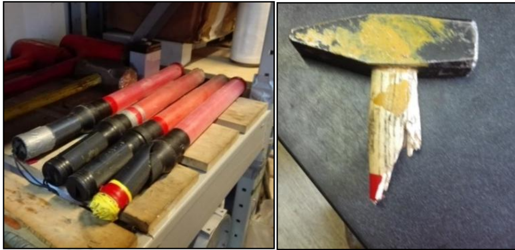
Fotografía 66: Herramientas en malas condiciones.
