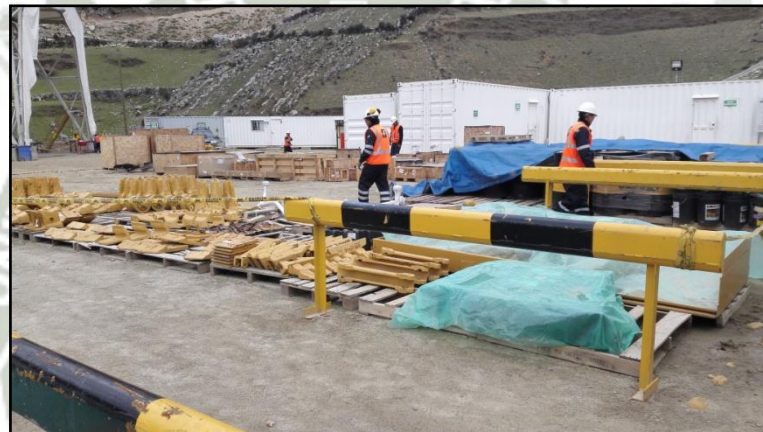
Fotografía 12: Almacén temporal de gets.
