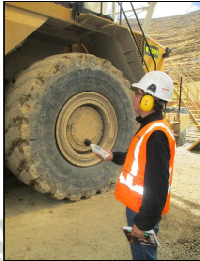
Fotografía 10: Medición de ruido en hangar Flota tradicional
