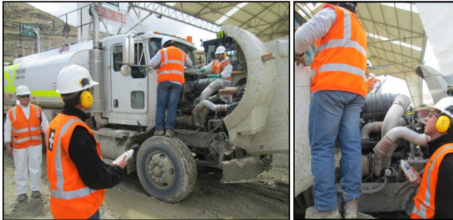
Fotografía 14: Medición de ruidos en zona de Motored/Unimaq
