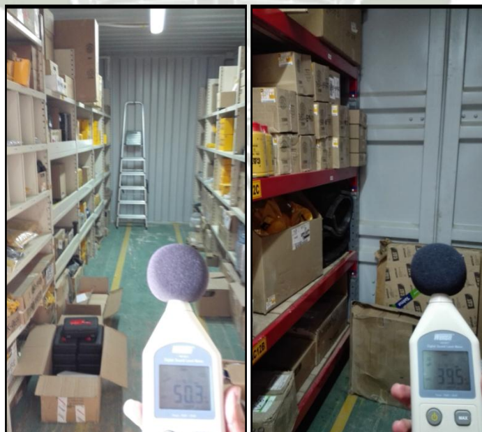
Fotografía 21: Medición de ruidos en oficinas de administración
