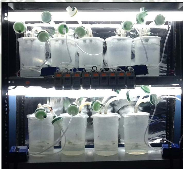
Figura N° 24: *Funcionamiento simultaneo de nueve reactores de inmersión temporal con sus respectivos temporizadores y bombas de aire.*
