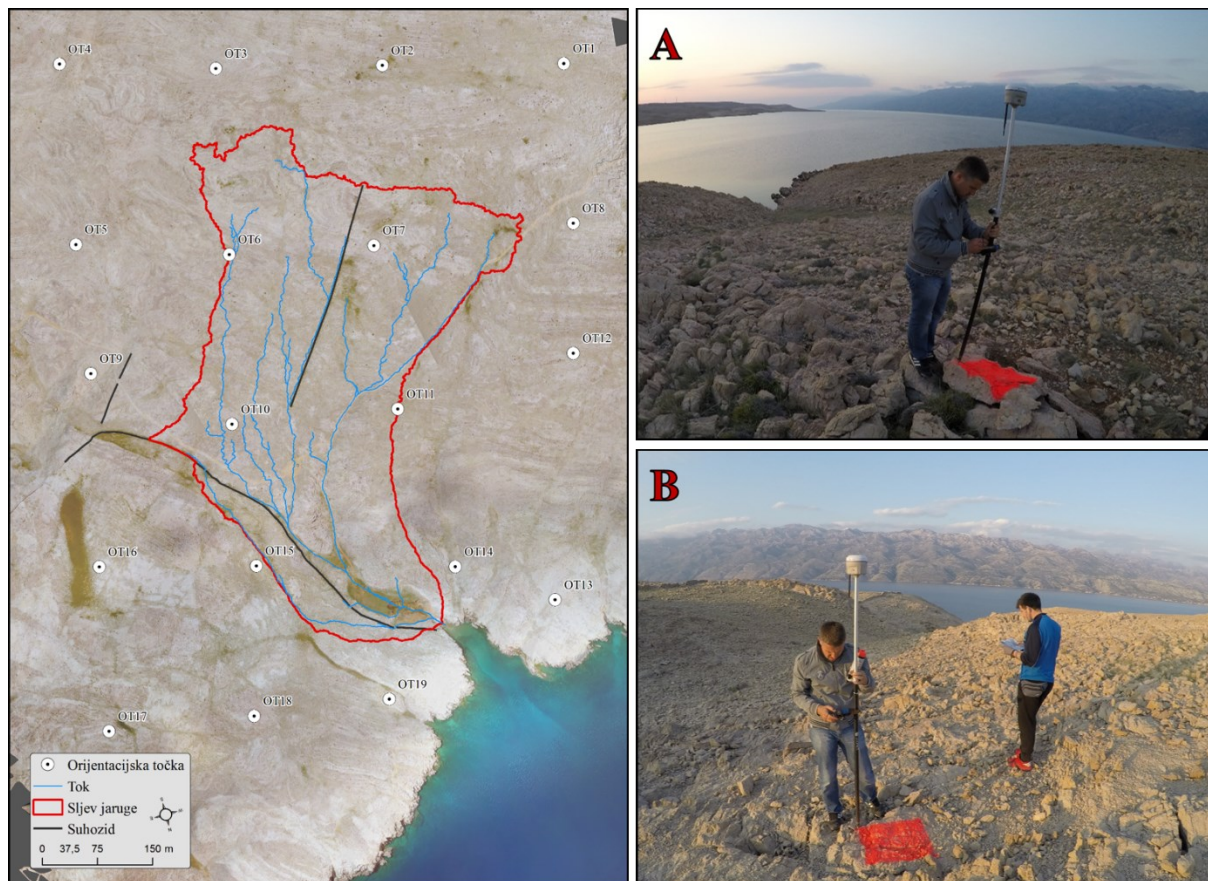
Slika 8. Plan snimanja prostora sliva jaruge Santiš (lijevo); primjer označavanja orijentacijskih točaka i prikupljanja njihovih preciznih koordinata (desno – A i B)
